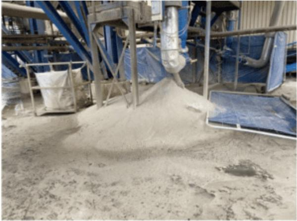
*Au centre, un tas de REFIOM - A gauche, un des sacs de stockage - Encore plus à gauche : les eaux de pluie...*
